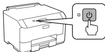
電源ランプが点滅しないときは電源コードの接続を確認してから【電源】ボタンを長めに押して、電源を入れ直してください。
