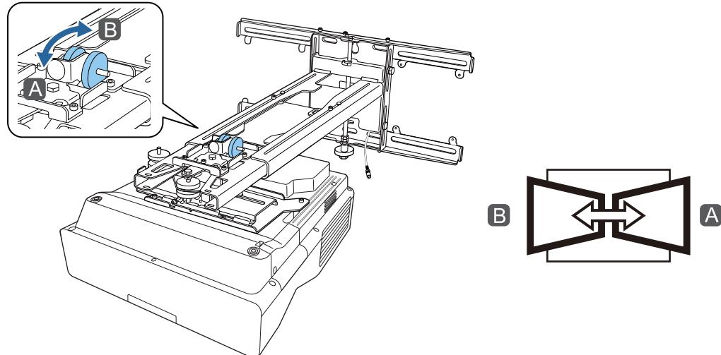
5 转动安装导轨中的调节旋钮 ③ 以调节垂直倾斜
