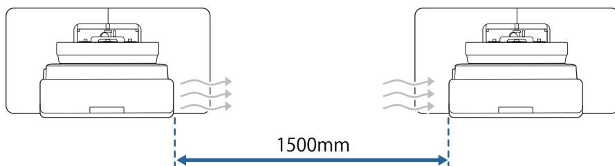
如果不能保证约1,200 mm的间距，请安装隔板以阻挡从投影机排气口排出的热量。
