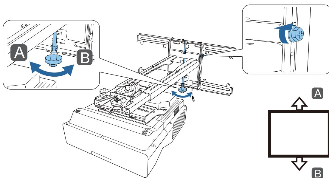
9 重新拧紧步骤3到8中松开的螺钉和螺栓
