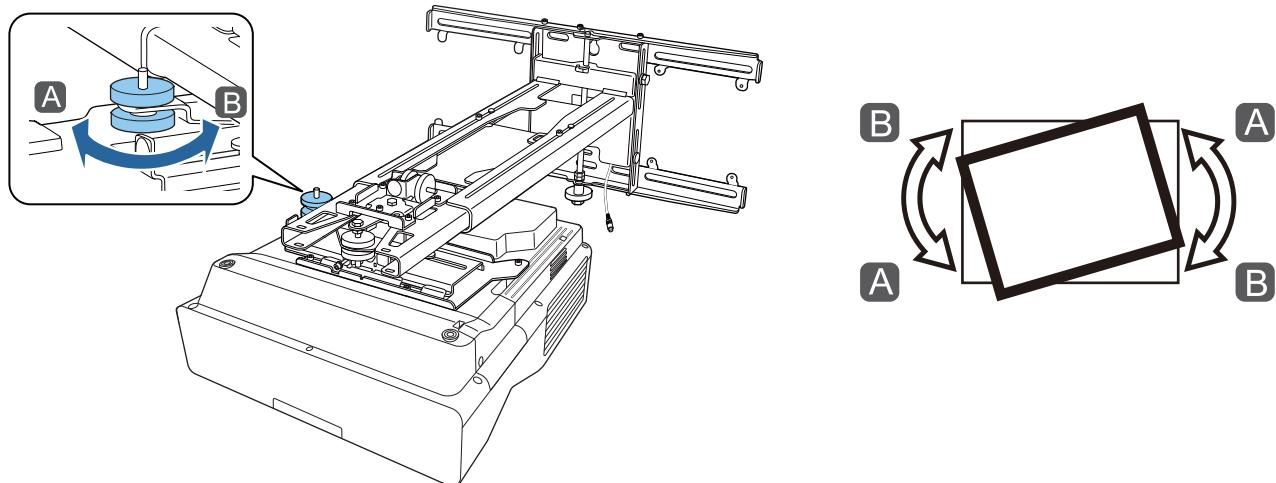
4 转动安装导轨中的调节旋钮 ② 以调节水平旋转
