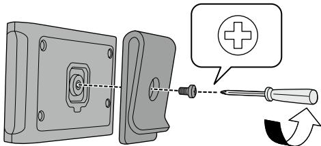
通过更改带夹方向，您可以将接口盒旋转 90 度。
