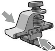
將頭戴式顯示器戴到眼鏡上時，將其往前移動以挪出足夠的調整空間，調整頭盔安裝托架的滑桿。
