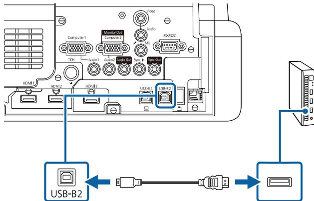
**3** 将另一端连接到计算机上可用的 USB 端口。
