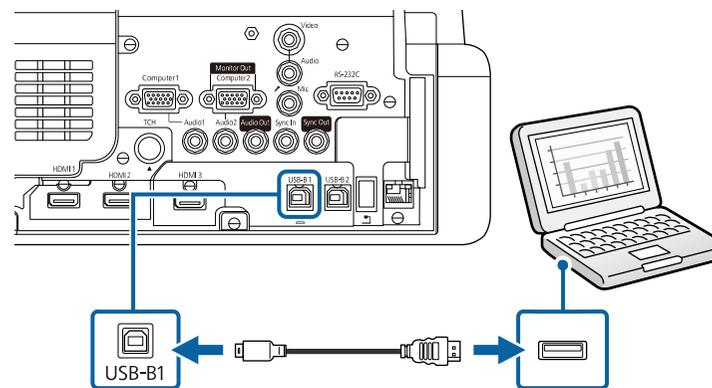
**3** 将另一端连接到计算机上可用的 USB 端口。
