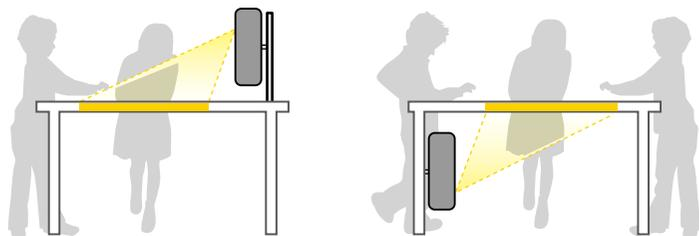
根据安装方法在投影机的安装菜单中选择正确的投影模式选项。如有必要，启用投影机操作菜单中的反转方向按钮设置，并调节投影机显示设定菜单中的菜单旋转设置。
