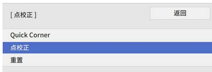
要进行微调，请选择 **Quick Corner** 粗略校正图像的形状和大小，然后选择点校正对图像进行精确调节。
