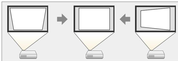
您可以使用梯形校正按钮将图像上下左右校正 3°。
