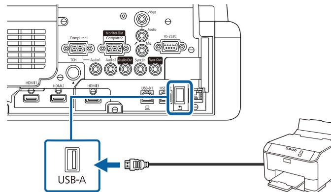
**2** 将电缆的另一端连接到打印机上的 USB Type B 端口。
