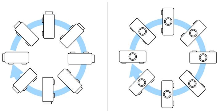
使用交互功能时，无论投影机怎样放置，投影机的倾斜角度都不能超过 3° (CB-735Fi/CB-725Wi)。
