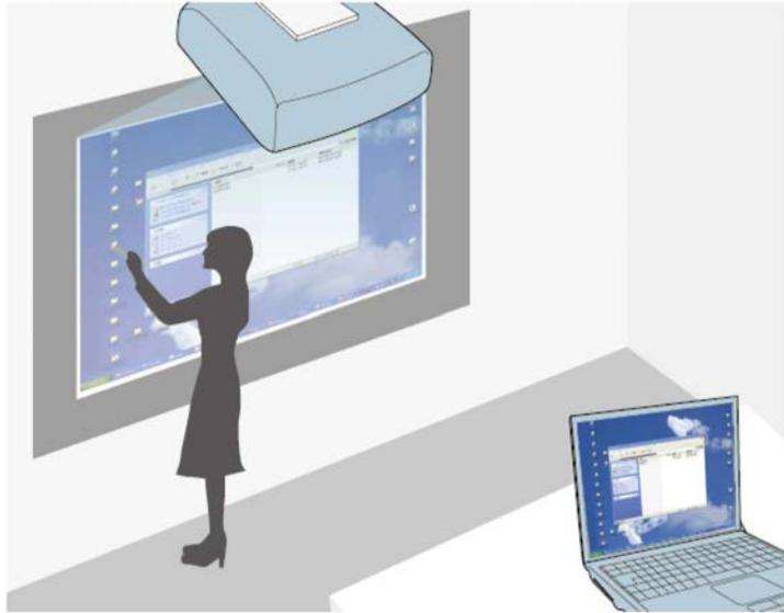
投影机通过 USB 电缆、Epson iProjection 或 Screen Mirroring 连接到计算机之后，您可以使用互动笔或手指通过投影屏幕操作计算机，就像用鼠标操作计算机一样。您可以通过投影屏幕进行浏览、选择以及与计算机程序互动。
