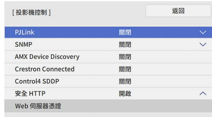
**4** 將 Crestron Connected 設定設為開啓，以允許偵測投影機。
