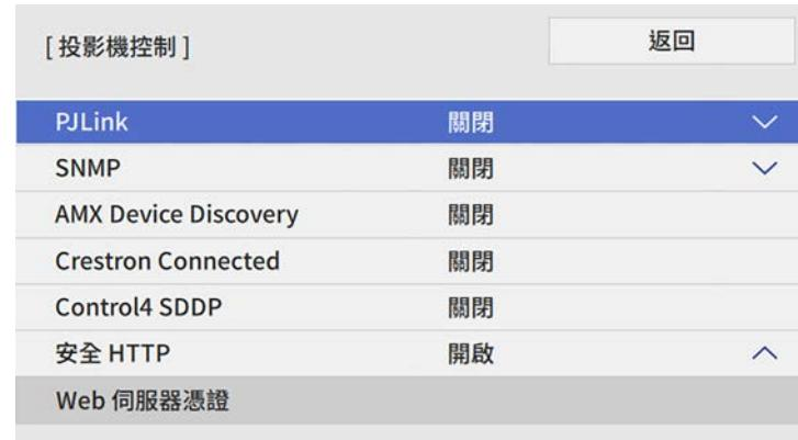
**4** 將 Crestron Connected 設定設為 開啟，以允許偵測投影機。
