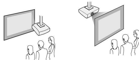
根據您所使用的安裝方式，請從投影機**安裝**選單，選擇正確的**投影方式**選項。如有需要，開啟投影機**操作**選單中的**反轉方向按鈕**設定，並調整投影機**顯示**選單中的**選單旋轉**設定。
