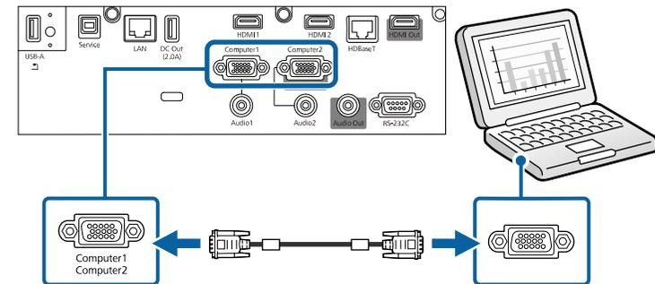
**3** 鎖緊 VGA 連接器上的螺絲。
