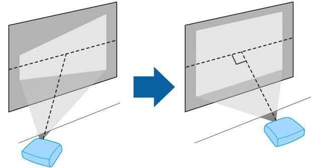
프로젝터가 똑바로 스크린을 향하도록 배치할 수 없을 경우 프로젝터 컨트롤을 이용해서 키스톤 왜곡을 보정하십시오. 최상의 화질을 얻으려면 영상의 크기와 모양이 정확하도록 프로젝터의 설치 위치를 조정하는 것이 좋습니다.
