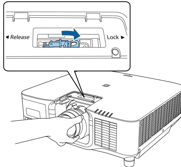
**6** 若要更牢固地固定鏡頭，請使用六角扳手 (2.5mm) 鎖緊鎖桿旁的螺絲。
