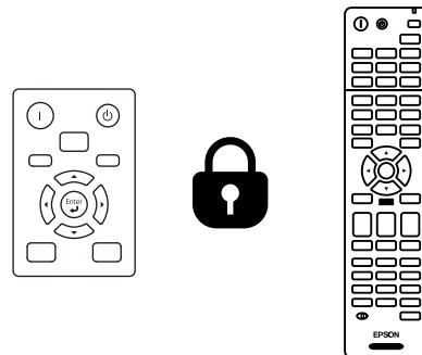
即使鎖定操作面板上的按鈕，仍可照常使用遙控器。
