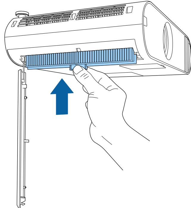
**5** 請用吸塵器清潔防塵濾網的兩側，清除殘留的灰塵。
