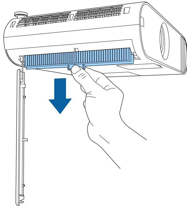
**6** 放置防塵濾網，使濾網兩側的導引道順著投影機的導槽滑入，然後輕輕往上推到不會掉下的位置。
