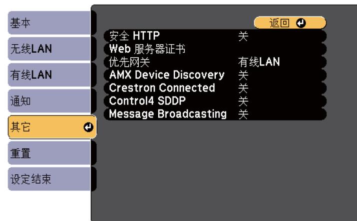
**4** 将 **Crestron Connected** 设定为开以便检测投影机。
