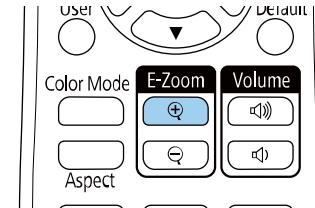
投影的图像围绕图像的中心放大。您能够以 25 个增量级将图像放大 1 至 4 倍。
