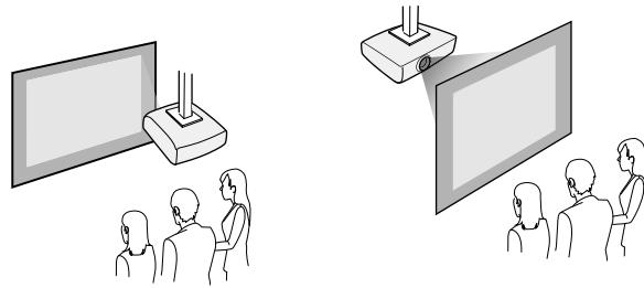
根据安装方法在投影机的**安装**菜单中选择正确的**投影模式**选项。如有必要，启用投影机**操作**菜单中的**反转方向按钮**设置，并调节投影机**显示**设定菜单中的**菜单旋转**设置。
