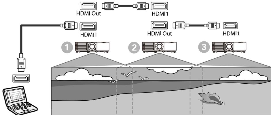
**1** HDMI 케이블을 사용하여 프로젝터를 컴퓨터에 연결한 후 HDMI 케이블을 사용하여 프로젝터의 HDMI1 포트와 HDMI Out 포트를 연결합니다.
