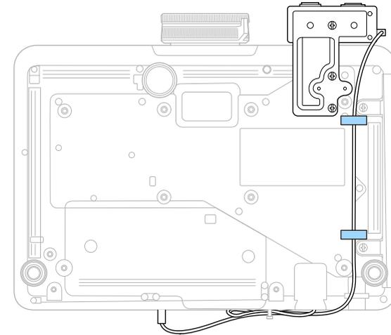
**2** USB 케이블의 끝을 프로젝터에 연결하고 케이블 타이로 프로젝터의 케이블 홀더에 통과시킨 후 USB 케이블을 접어서 케이블 타이로 고정합니다.
