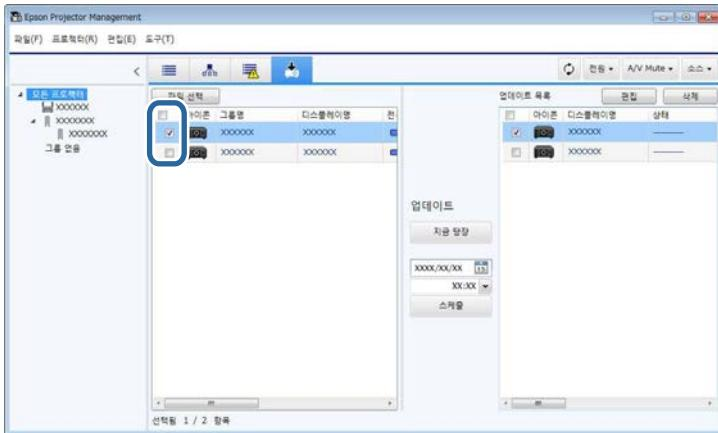
설정된 날짜 및 시간에 메뉴 설정이 복사되고 프로젝터의 LED 표시등이 켜집니다. 메뉴 설정 복사가 완료되면 프로젝터가 꺼지면서 대기 모드로 전환됩니다. 복사하는 동안 [업데이트 목록] 보기의 오른쪽 창에서 메뉴 복사 상태를 확인할 수 있습니다.
