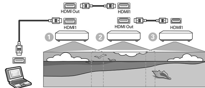
**1** 使用 HDMI 纜線將投影機連接至電腦，再使用 HDMI 纜線連接投影機的 HDMI1 In 埠和 HDMI Out 埠。
