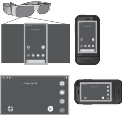
Im Headset und am Gerät wird derselben Bildschirm angezeigt.
