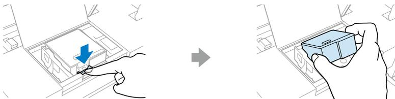
**8** 新しいカートリッジを斜めに挿入し、[押す] の部分をゆっくり押し
