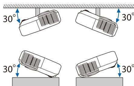
使用投影機時，傾斜角度若超過 30°，可能會導致投影機損壞而造成意外。
