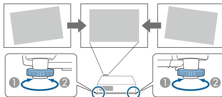
將投影機放在屏幕中央的正前方並保持水平，可投影出規則的矩形影像。若投影機與屏幕成斜角位置、向上或向下傾斜或斜向一邊，則可能需要修正影像形狀。
