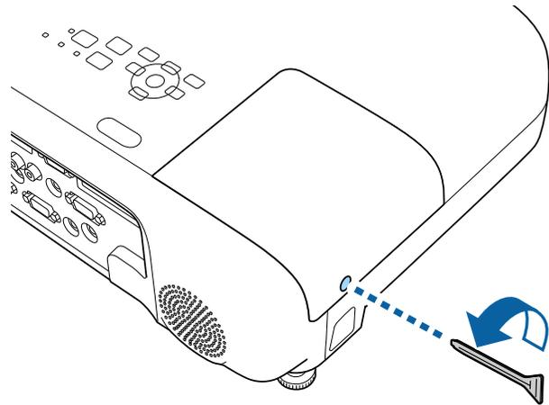
**5** 鬆開將燈泡固定至投影機的螺絲。不要完全拆下螺絲。
