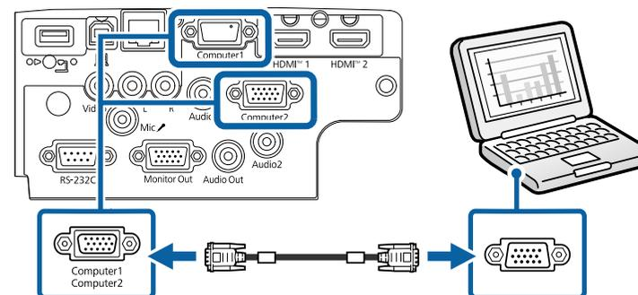
**3** 鎖緊 VGA 連接器上的螺絲。
